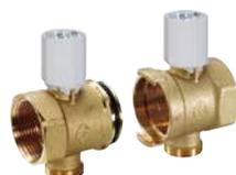
Coppia di collettori modulari di ritorno terminali, ad aggancio rapido, con valvole di intercettazione dotate di volantino manuale, predisposte per comando elettrotermico. In ottone. Con attacchi per adattatore tubo rame, plastica o multistrato. Interasse attacchi moduli assemblati 50 mm. Campo di temperatura 5÷110 °C. Pressione massima di esercizio 10 bar.
