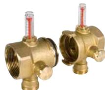
Coppia di collettori modulari di mandata terminali, ad aggancio rapido, con misuratori di portata e detentori frontali di bilanciamento dotati di memoria meccanica. In ottone. Con attacchi per adattatore tubo rame, plastica o multistrato. Interasse attacchi moduli assemblati 50 mm. Campo di temperatura 5÷110 °C. Pressione massima di esercizio 10 bar.
