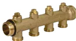
Collettore componibile di mandata, con detentori di bilanciamento, in ottone, per impianti di climatizzazione. Attacchi per adattatore tubo rame, plastica o multistrato. Interasse tra gli stacchi 50 mm. Campo di temperatura 5÷110 °C. Pressione massima di esercizio 10 bar.
