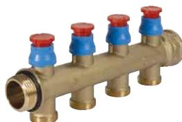
Collettore componibile di ritorno, con valvole di intercettazione con volantino manuale predisposte per comando elettrotermico previa installazione dell'apposita ghiera adattatore, in ottone, per impianti di climatizzazione. Attacchi per adattatore tubo rame, plastica o multistrato. Interasse tra gli stacchi 50 mm. Campo di temperatura 5÷110 °C. Pressione massima di esercizio 10 bar.
