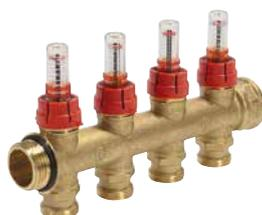
Collettore componibile di mandata, con misuratori di portata con doppia scala (0,5÷5 l/min e 0,15÷1,5 GPM) con funzione di regolazione/intercettazione del fluido, in ottone, per impianti di climatizzazione. Attacchi per adattatore tubo rame, plastica o multistrato. Interasse tra gli stacchi 50 mm. Campo di temperatura 5÷70 °C. Pressione massima di esercizio 6 bar.
