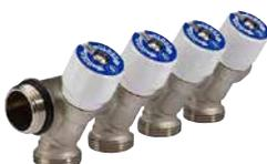
Collettore componibile con rubinetti di intercettazione e O-Ring di tenuta per impianti sanitari, in ottone nichelato. Attacchi per adattatori tubo rame, plastica o multistrato.
