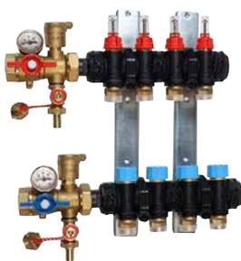
Kit collettore premontato in tecnopolimero, per impianti di climatizzazione, con misuratori di portata. Attacchi per adattatori tubo rame, plastica o multistrato. Interasse tra gli stacchi: 50 mm. Campo di temperatura 5÷60 °C. Pressione massima di esercizio 6 bar (10 bar per collaudo impianto).
