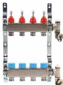
Kit collettore premontato in acciaio inossidabile, per impianti di climatizzazione, con misuratori di portata. Attacchi per adattatori tubo rame, plastica o multistrato.
