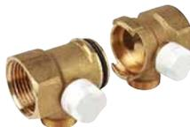
Coppia di collettori modulari terminali, ad aggancio rapido per impianti sanitari, con rubinetti di intercettazione. In ottone. Attacchi per adattatore tubo rame, plastica o multistrato. Interasse attacchi moduli assemblati 35 mm. Campo di temperatura 5÷90 °C. Pressione massima di esercizio 10 bar.
