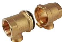
Coppia di collettori modulari terminali ad aggancio rapido, in ottone. Attacchi per adattatore tubo rame, plastica o multistrato. Interasse attacchi moduli assemblati 35 mm (DN25) o 50 mm (DN32). Campo di temperatura 5÷90 °C. Pressione massima di esercizio 10 bar.
